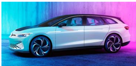
Mit Durchströmungsöffnungen bei Stossfänger und Motorhaube
