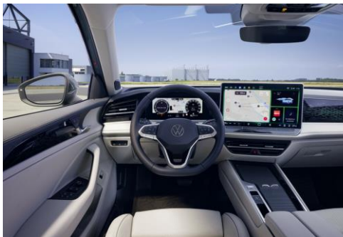
Le grand paysage d'affichage clairement structuré avec un écran de 12,9 pouces de série (15 pouces en option).
